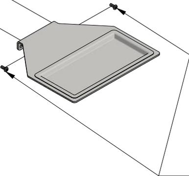
Abtropfblech (optionaler Artikel) mittels beiliegender M5 Rundkopfschrauben befestigen.
